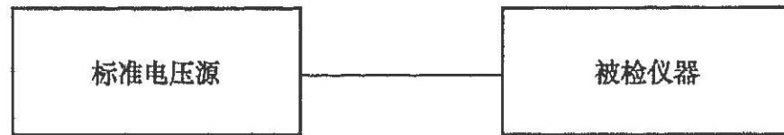
图 1 标准源法电压测量误差检定示意图
