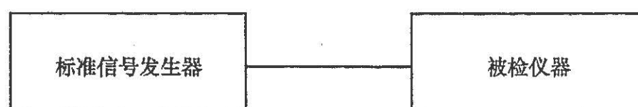
图 3 标准源法频率测量误差检定示意图
