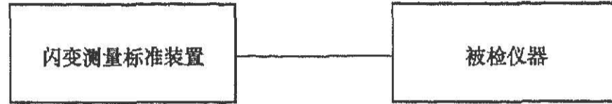
图 9 标准源法闪变值检定示意图
