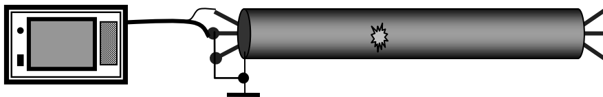
图七、低压脉冲测试接线图
